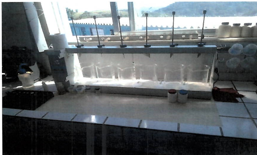
Foto 15 – Ensaio de Floculação (Jar Test) realizado 4 vezes ao dia.
